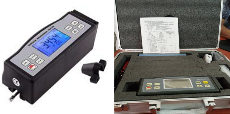
الشكل (4) يبين جهاز قياس خشونة السطح
