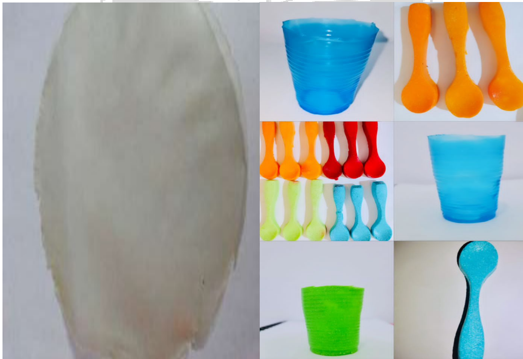
شكل (5) تشكيل الأغشية و تصنيع بعض الادوات المنزلية من البلاستيك الحيوي
